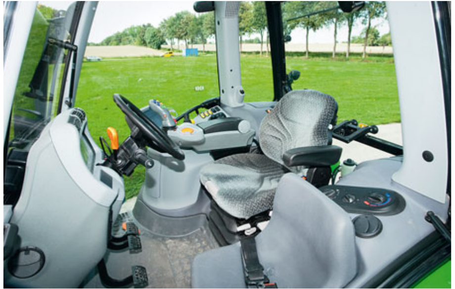
Die Kabine ist nach wie vor geräumig, leise und bietet auch mit 6 Pfosten eine gute Rundumsicht. Die mechanische Kabinenfederung ist Serie, die Luftfederung kostet 1 550 Euro extra.
