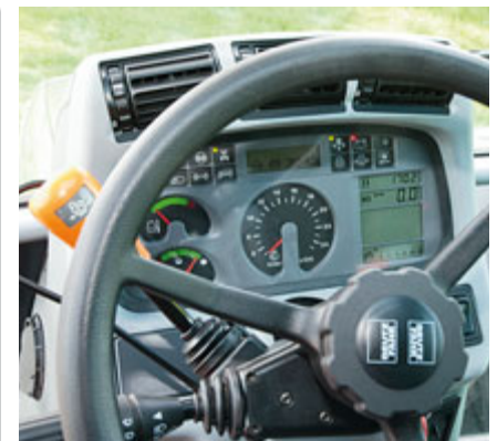
Übersichtlich und mit den wichtigsten Infos auf einen Blick – das Armaturenbrett. Leider kann man den Wendeschalthebel links noch immer nicht im Wechsel mit den Knöpfen rechts im Joystick nutzen.
