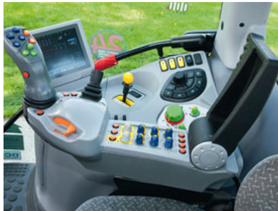
Ohne den iMonitor werden viele Einstellungen einfach mit den Reglern unter der Armlehne gemacht. Die Bedienung und etliche Funktionen des TTV sollte Deutz-Fahr trotzdem noch verbessern.
